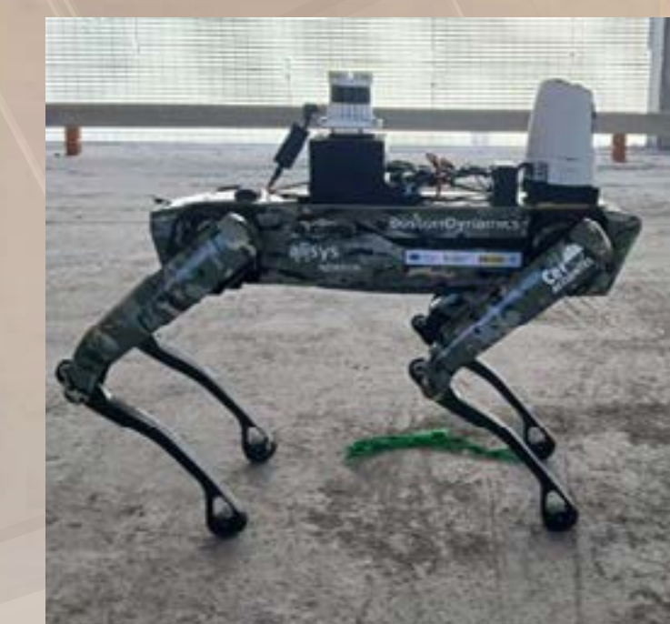
Spot integrado con sistema LiDar y Cámara RGB.
