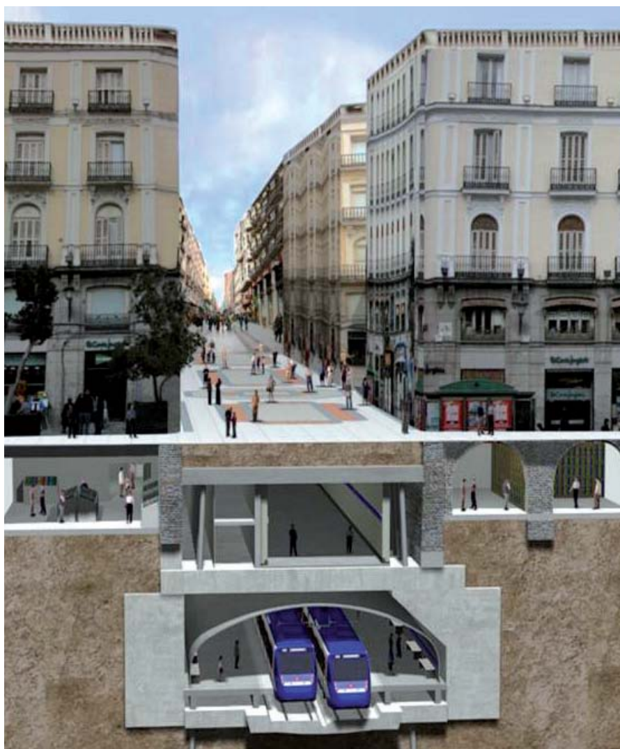
Ampliación de andenes y nuevo vestíbulo en la estación de Sol, Línea 3 del Metro de Madrid
