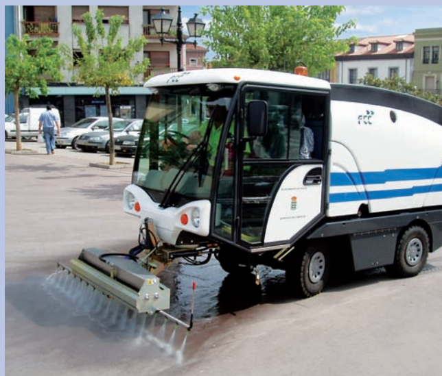
Limpieza viaria. Baldeo mecánico de aceras. Vitoria y Oviedo
