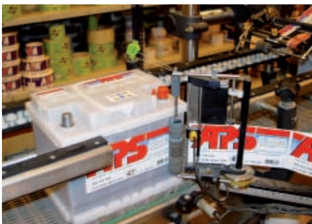
Logística. Etiquetado automático de baterías
