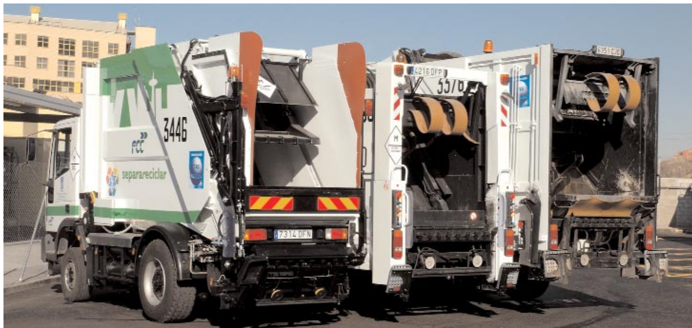
■ Recolectores de residuos sólidos urbanos propulsado por gas natural
