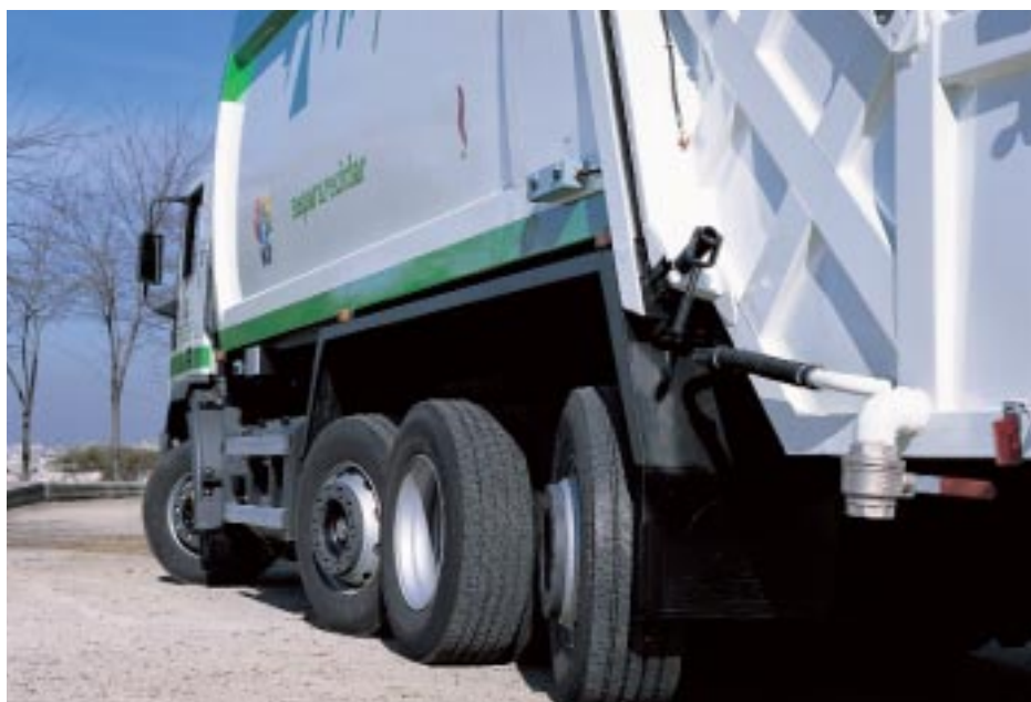
Camión recolector con tres ejes directrices
