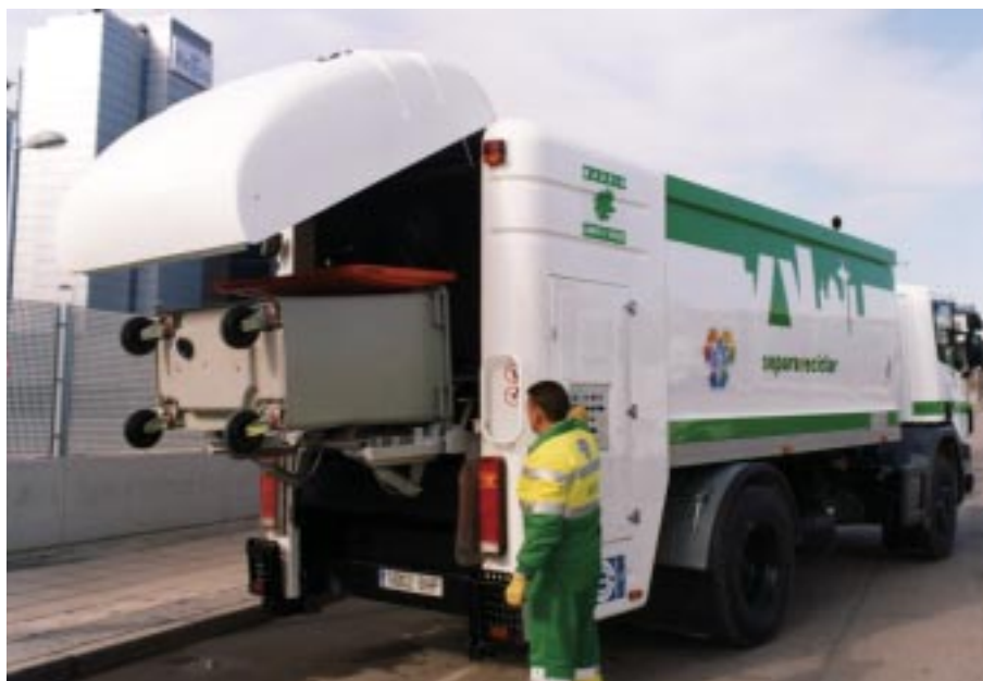
Limpieza hermética de contenedores con agua reciclada. Madrid
