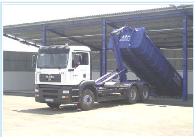
Vehículo de carga contenedores para residuos voluminosos
