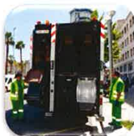
Recogida orgánica y de restos mediante vehículo bicompartimentado
