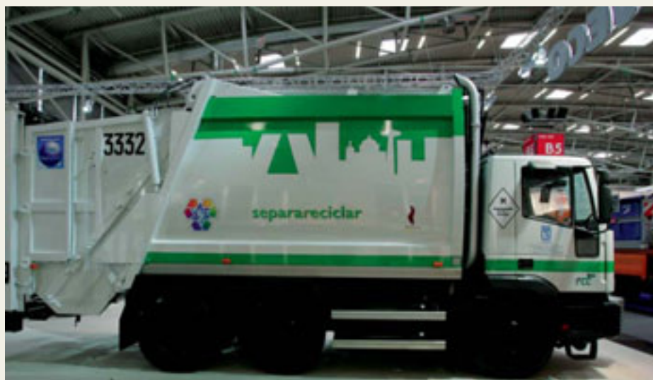
FCC TIENE ACTUALMENTE EN SERVICIO 210 equipos: con carrocería de 25 m 3 de capacidad, del entorno de 120 (35 sobre autobastidor de GNC) y con carrocería de 18 m 3 de capacidad, unos 90 (60 sobre autobastidor de GNC).
