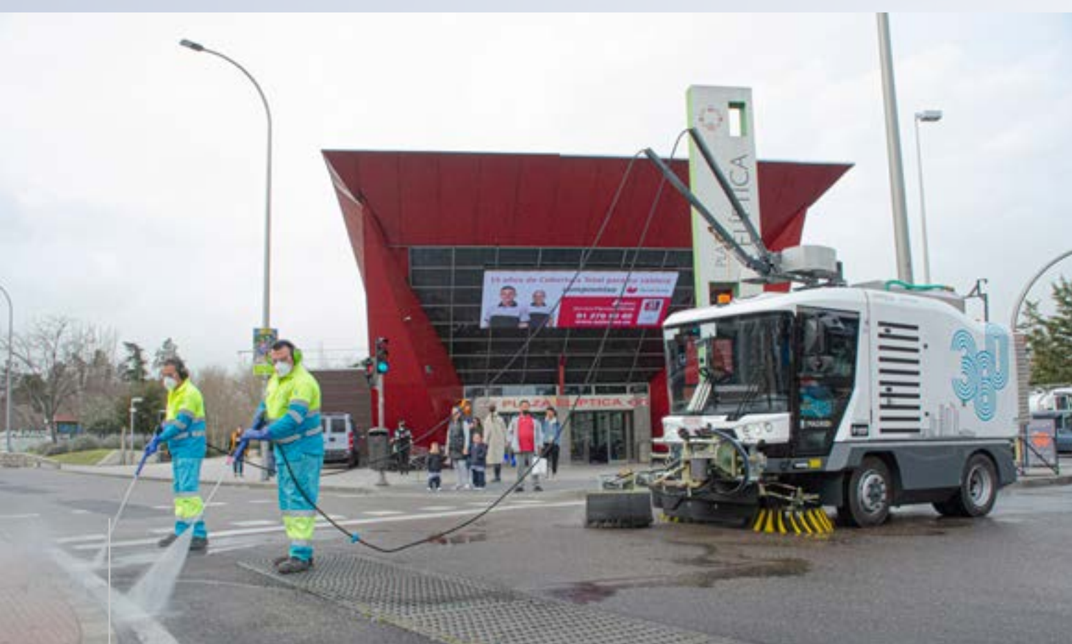
PLAUSU, barredora-baldeadora 100 % eléctrica que incorpora sistemas de navegación autónoma, sensores avanzados e inteligencia artificial para optimizar las operaciones de limpieza urbana.
